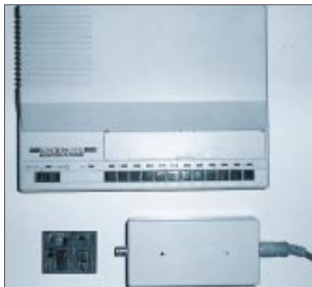
Bild 7: Ein kompletter Tuner mit Stationstasten, der von unterschiedlichen Firmen zur Hochzeit des Commodore C-64 vertrieben wurde, um den damals „hochwertigen“ Videomonitor auch als Fernseher nutzen zu können. Im Vordergrund Prozessorplatine und konventionelles Modul im Vergleich.
