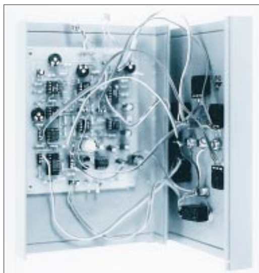
Bild 9: Am geöffneten Gerät sieht man die Verbindungen zur Frontplatte. Der hintere Raum nimmt die Batterie auf.
